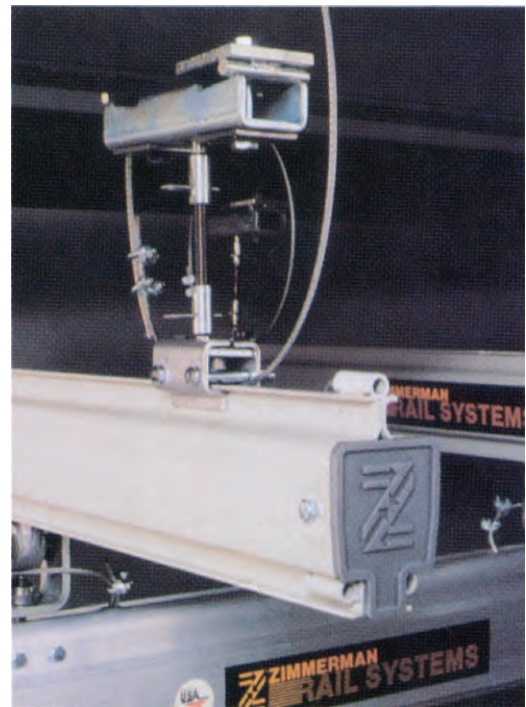
軽量物搬送システム（Zレール）
