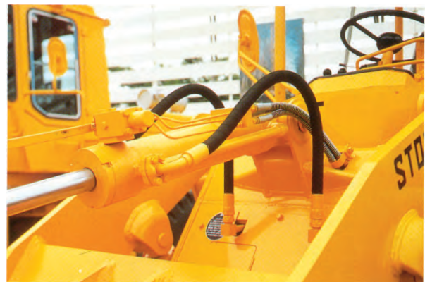
建設機械配管
