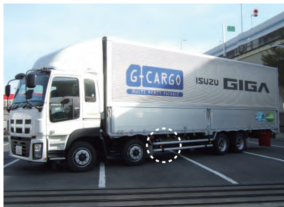
尿素水タンクを搭載した車両（点線部）
